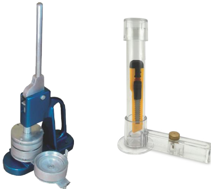
Maquina manual para elaborar botones a presión.
